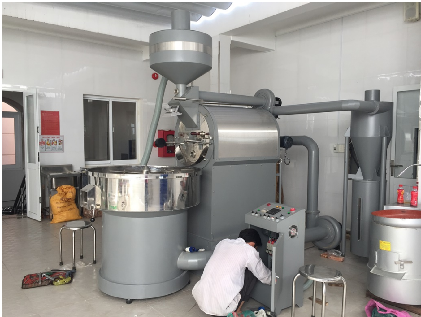
Lắp đặt máy rang cafe 30 kg-mẻ cho khách hàng Q 12, TP. HCM
