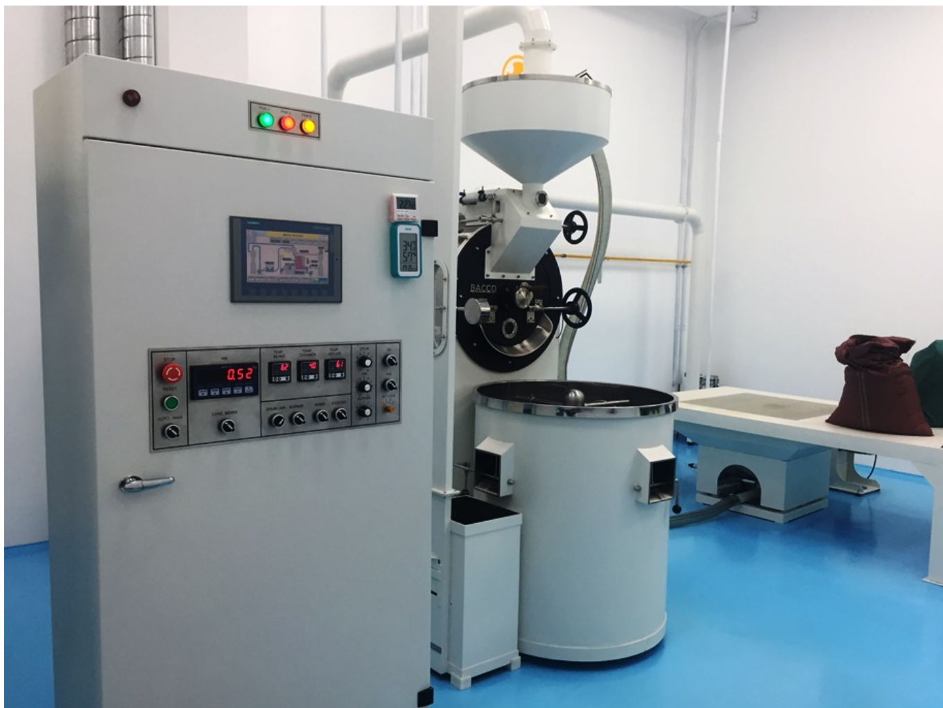
Lắp đặt hệ thống máy rang cà phê 120kg.me
