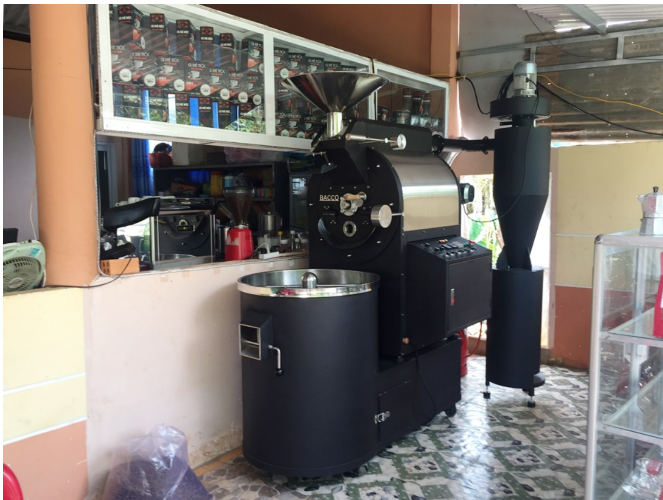
Lắp đặt và test máy rang 2 kg-mẻ cho khách hàng Q 12, TP. HCM
