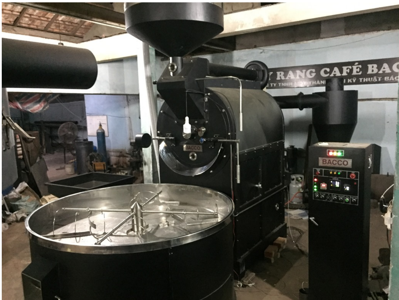
Lắp đặt máy rang cafe 10 kg-mẻ cho khách hàng Q1, TP. HCM
